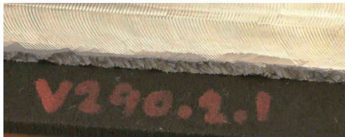
Figur 6, Urflisningar på en 90° kant vid utgång för skär. [MacAM]
