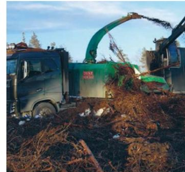
Flisning av grot vid bilväg. Här flisas groten med en så kallad lastbilshugg direkt i ett lastbilssläp.
